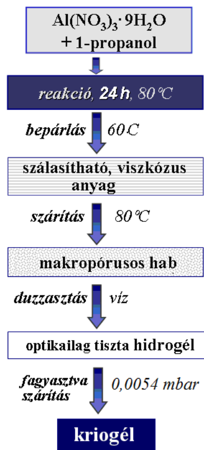
5.1. ábra. Az alumínium-oxid kriogélek előállítása szol-gél módszerrel [1]
