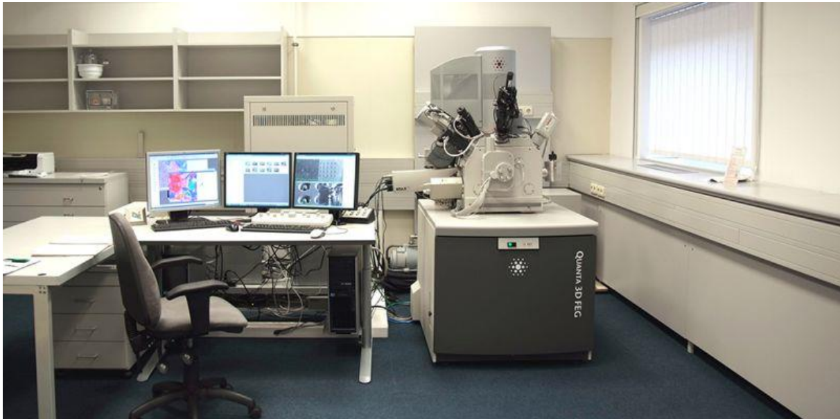
4.3. ábra. A pásztázó elektronmikroszkópos mérésekhez használt FEI Quanta 3D FEG mikroszkóp (kép forrása: sem.elte.hu).
